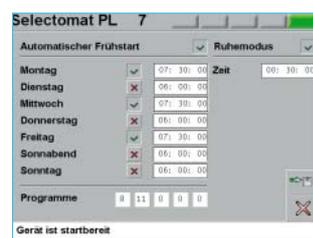
Das Frühstart-Programm beginnt selbsttätig mit der Aufwärmphase und einem ersten Leerdurchlauf. Der Selectomat PL ist sofort einsatzbereit, wann immer er gebraucht wird.
