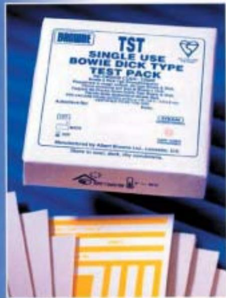
Při sterilizaci, jež součástí je odstranění zbytkového vzduchu z výrobku, musí být prováděna zkouška pronikavosti páry (CSN EN 554) na počátku každého pracovního dne.
