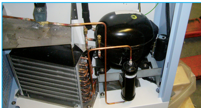
У аппарата CLC 404 размещение компрессора остаётся в прежнем держателе
