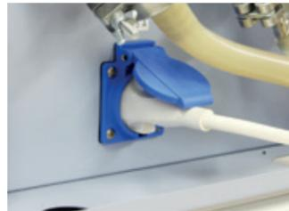
Enchufe para la conexión y mando de la bomba de aire
