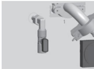
Válvula manual/de emergencia de aireación
